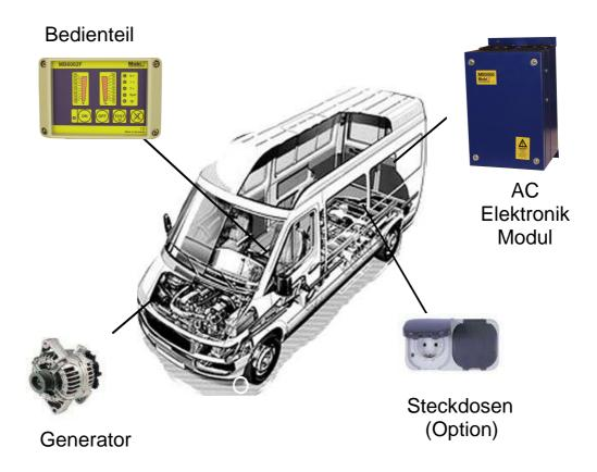
Die Lösung heißt **MB7500**. Die Systeme bestehen aus je einem Generator und einem AC-Elektronikmodul, einem Bedienteil und Steckdosen. AC Modul, Bedienteil und Steckdosen werden an beliebigen Stellen im Fahrzeug eingebaut. Der Generator wird vom Fahrzeugmotor angetrieben. Das AC-Modul liefert eine 50 Hz Wechselspannung von AC 230 V - und das mit einer Spitzenleistung von 7,5 kW. (Nennleistungen 6,2 kW).
