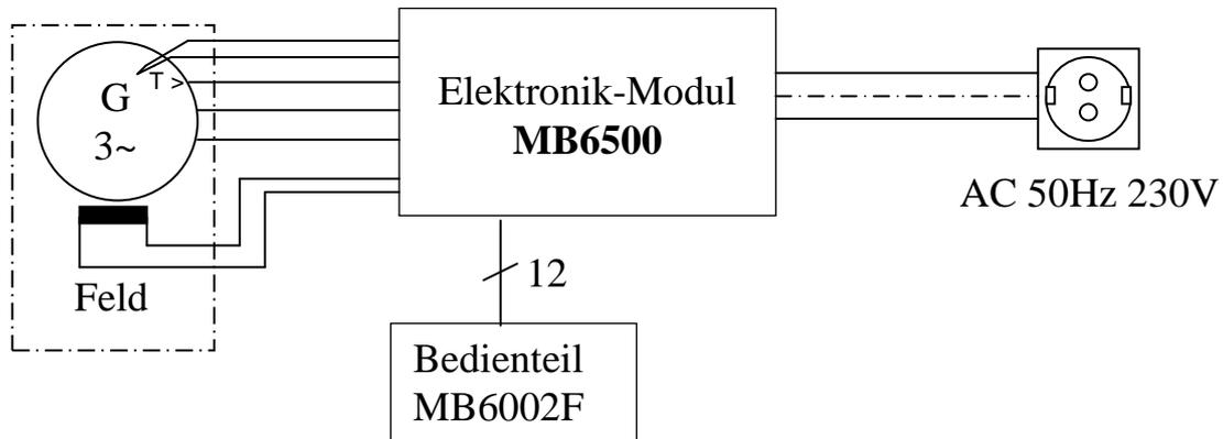
Der vom Fahrzeugmotor angetriebene Generator liefert eine variable Dreiphasenspannung mit drehzahlabhängiger Frequenz. Das Elektronikmodul regelt über die Feldwicklung eine stabile Ausgangsspannung des Generators aus.
